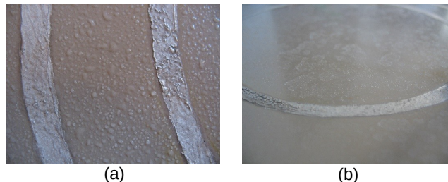
Obr. 2. Tvorba umelého znečistenia na povrchu glazovanej keramiky: a – nanosená vodivá elektrolytická vrstva; b – vysušená pevná vrstva znečistenia.
