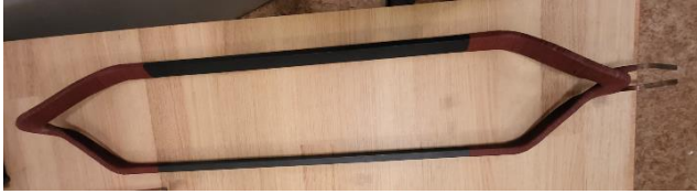
Obr. 1. Sistorová cievka s polovodičovým náterom
