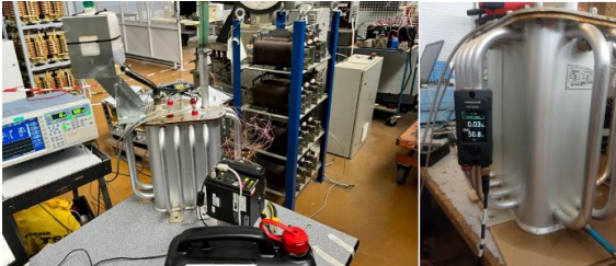
Obr. 1. Testovaný jednofázový transformátor s odporovou záťažou. Na chladiacich rúrkach transformátora je osadený prietokomer.
