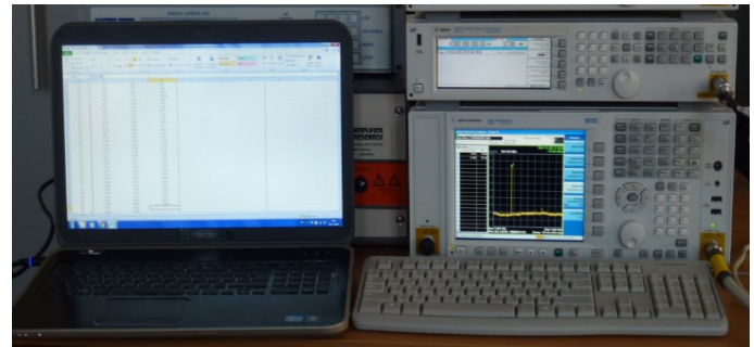
Obr. 1. Vonkajšia časť pracoviska pre účely merania účinnosti tienenia elektromagnetického poľa
