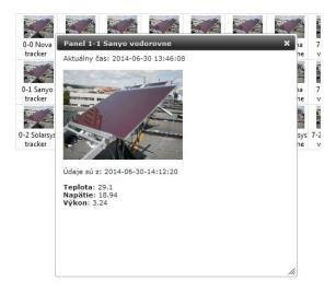
Obr. 3. Detail fotovoltického panelu s jeho nameranými parametrami
