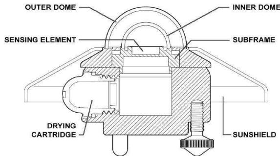
Fig. 1 Pyranometer Kipp&Zonen CMP 6 [3]
