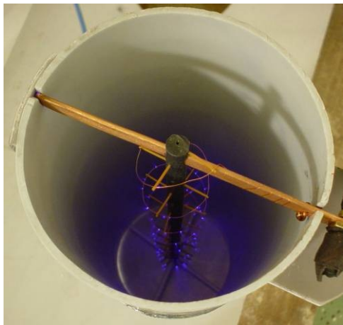
Obr.8. Korónový výboj v okolí špirálovitej elektródy ak nosná elektróda je kovová
