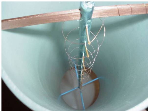
Obr.7. Umiestnenie špirálovitej korónujúcej elektródy.
