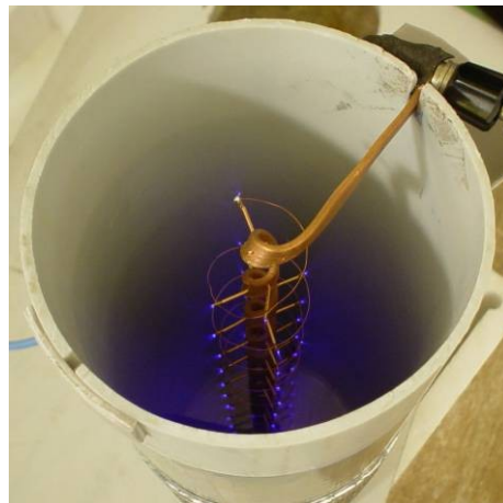
Obr.9. Korónový výboj v okolí špirálovitej elektródy ak nosná elektróda je z izolantu
