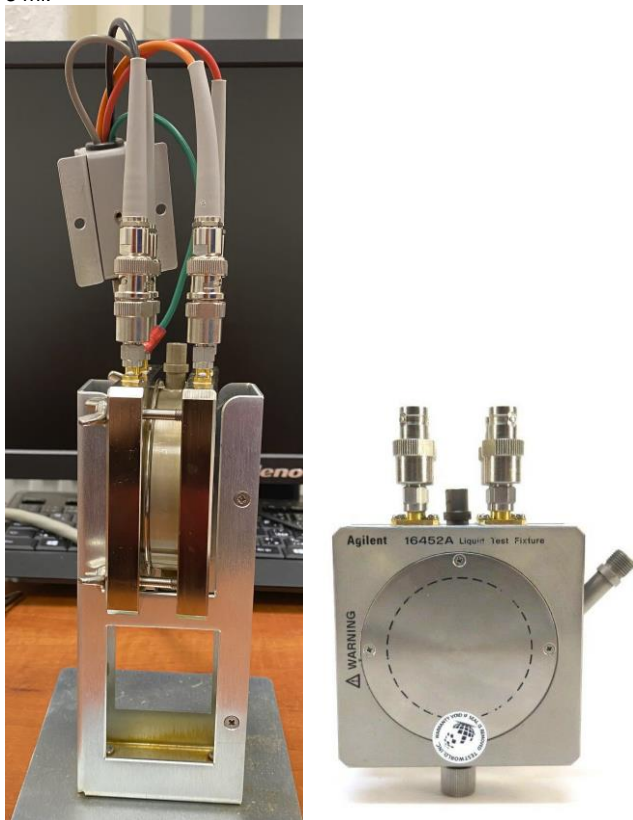
Obr. 1 Elektródový systém pre testovanie kvapalných izolačných materiálov Keysight 16452A
