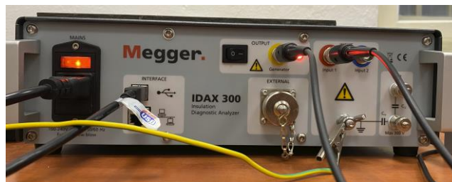
Obr. 2 Diagnostický analyzátor izolácie IDAX 300
