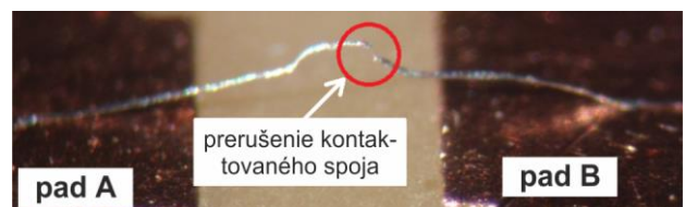
Obr.6. Porucha kontaktovaného spoja (preušenie) vplyvom termomechanického namáhania iniciovaného cyklickým prúdovým zatažením [16]
