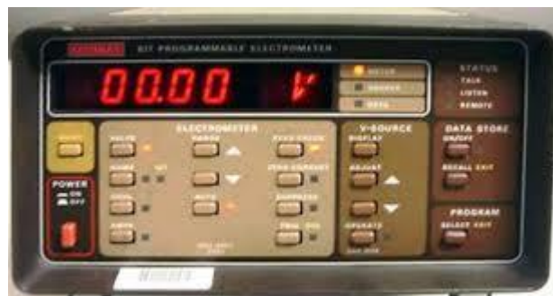
Obr.3. KEITHLEY K617 programovateľný elektrometer
