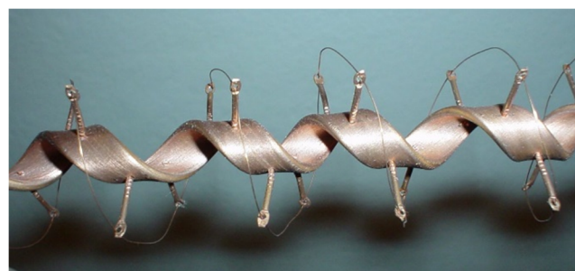
Obr.2. Celokovový nosič korónujúcej elektródy do prostredia s teplotami nad 100 °C
