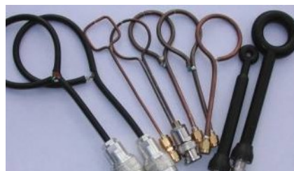
Obr.2 Rôzne typy sond používané na meranie EMC.
