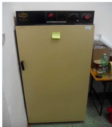
Obr.3. Sušiareň (blok "A")
