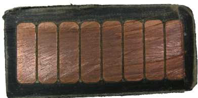
Obr. 1. Reálna drážková časť satorovej cievky v reze
