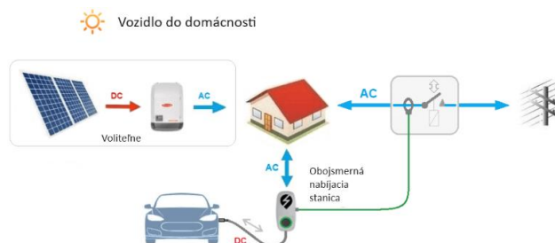
Obr. 2. Principiálna schéma zapojenia režimu vozidlo do domácnosti. [3]
