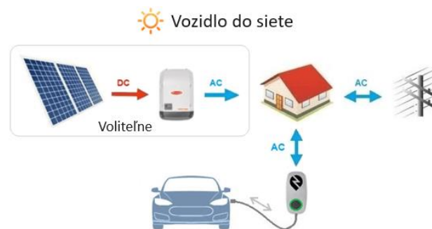
Obr. 1. Principiálna schéma zapojenia režimu vozidlo do siete. [3] energie vzhľadom na požadovaný stav nabitia batérie EV a požadovaného koncového stavu nabitia batérie. [2]
