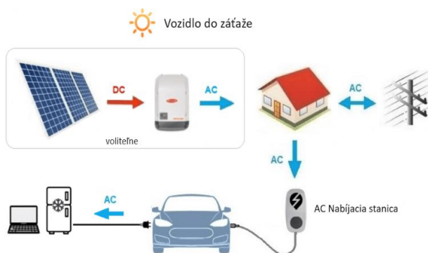
Obr. 3. Principiálna schéma zapojenia režimu vozidlo do zátáže. [3]
