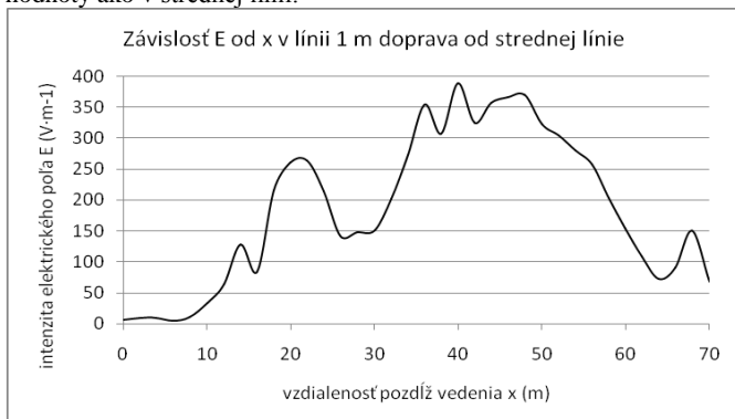
Obr. 5 Závislosť intenzity elektrického poľa od vzdialenosti pozdĺž vedenia v línii 1 m doprava od strednej línii vedenia 22 kV
