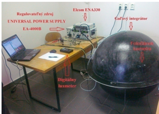
Obrázok 5. Meracia aparátúra pri meraní napäťových závislostí svetelného toku
