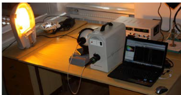
Obrázok 1. Meracia aparatúra pre meranie spektrálnych charakteristík svetelných zdrojov
