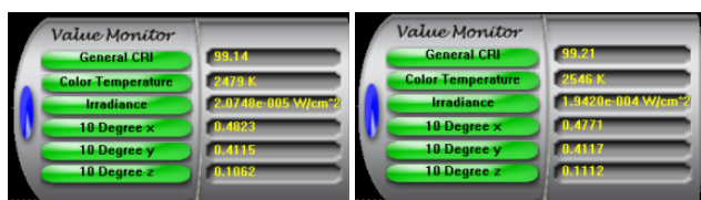
Obrázok 4a. Svetelnotechnické parametre klasickej žiarovky (vľavo) a halogénovej žiarovky (vpravo)
