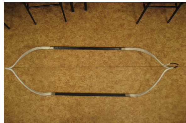
Obr. 5 Cievka bez polovodivej ochrany 6 kV asynchrónneho motora
